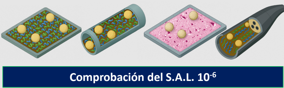
Figura 2. Representación de los cuatro modelos de desafío evaluados: superficies planas (acero inoxidable), lúmenes (HPCD), matrices orgánicas complejas y configuraciones tipo endoscopio. Todos los modelos fueron ensayados bajo condiciones worst-case, confirmando un nivel de aseguramiento de esterilidad SAL 10 -6 .
